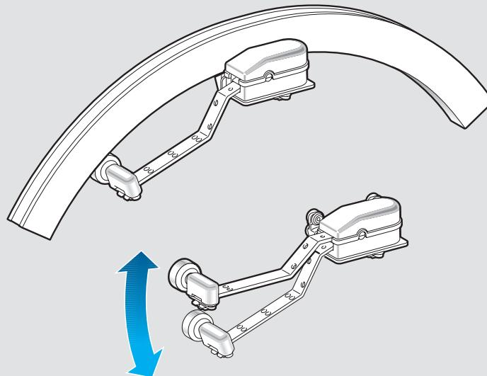
L'esclusiva asta di sormonto adattiva brevettata (art. 5523) permette la realizzazione di sistemi curvi con profilo a scomparsa anche di grandi dimensioni. La funzione basculante dell'asta di sormonto permette al telo di scorrere sempre al disotto del profilo.
